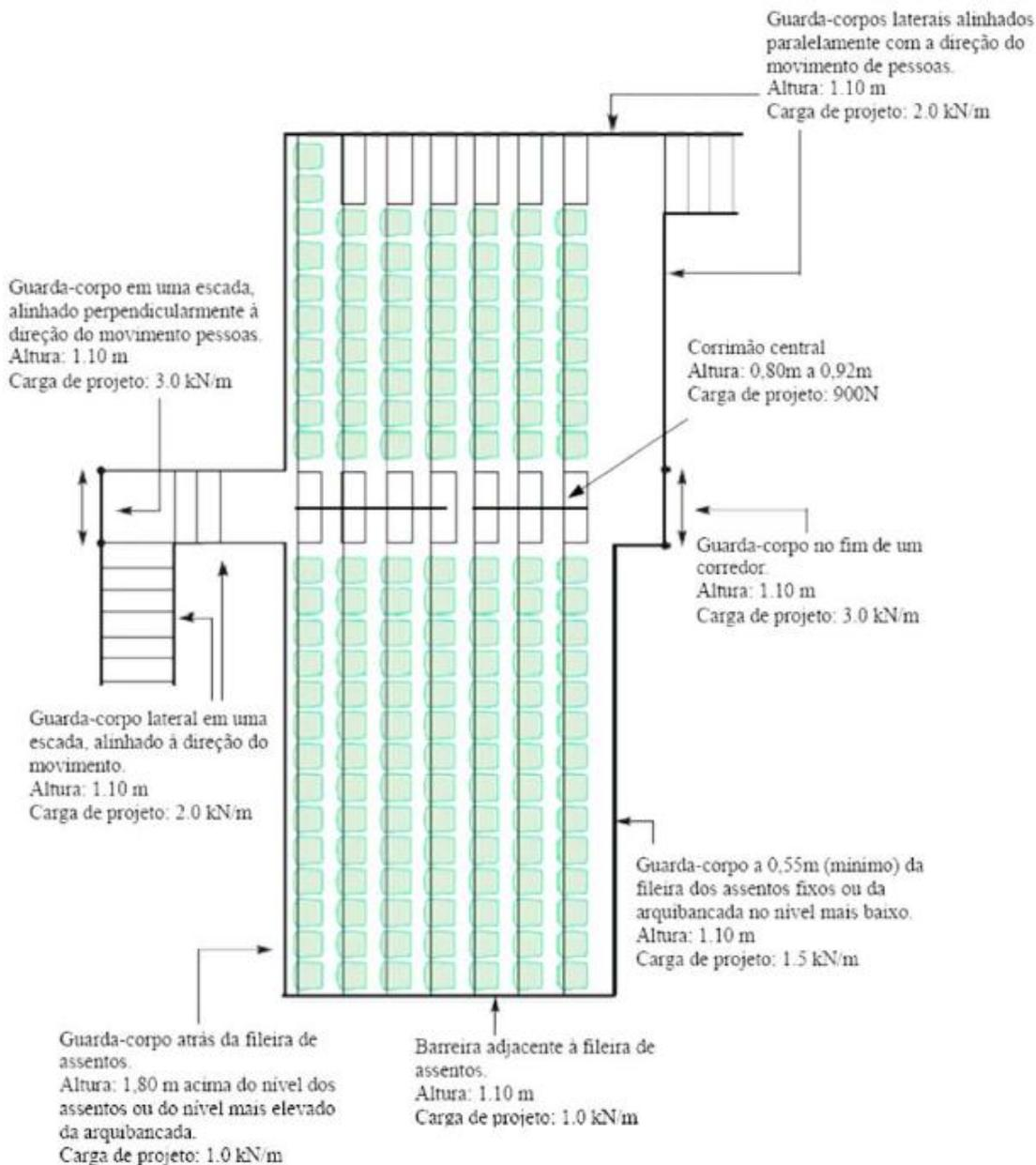
**Figura 5 : Barreiras, guarda-corpos e corrimãos centrais: cargas de projeto e altura mínimas e disposição**
