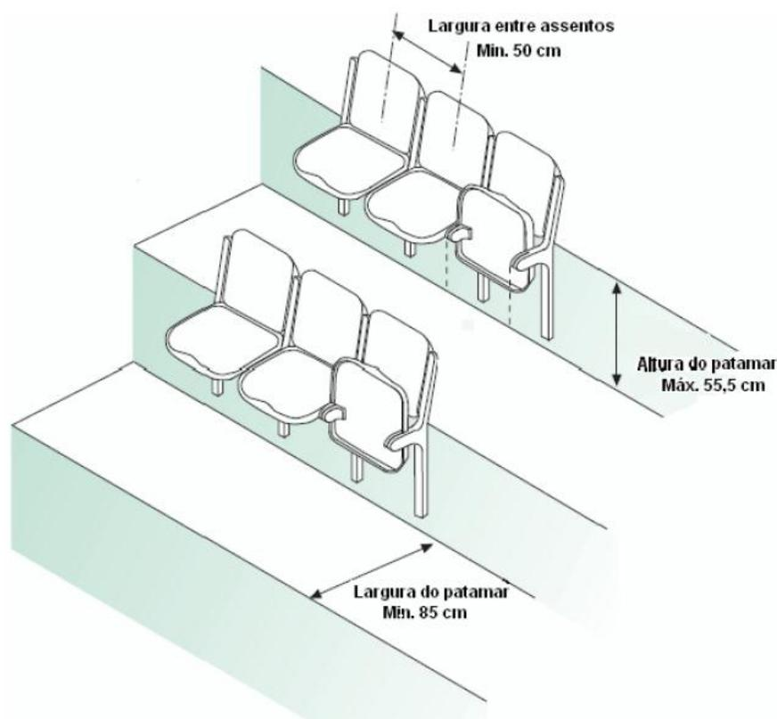
**Figura 2 - Detalhes das dimensões de largura e altura dos patamares. Fonte: Guide To Safety At Sports Grounds (Green Guide). 5.Ed. United Kingdom, 2008**
