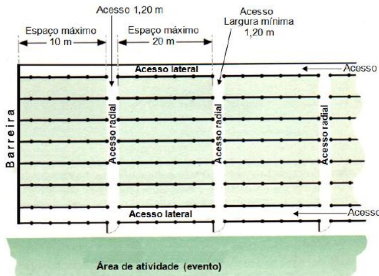
Figura 1 - Detalhe do comprimento e número máximo de assentos.
