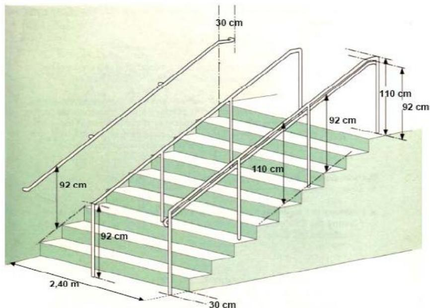
**Figura 4 - Dimensões dos corrimãos e guarda-corpo das escadas.**
