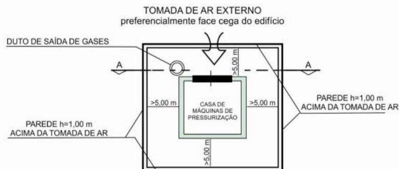
Figura 5 – Indicação das paredes afastadas a mais de 5 m da tomada de ar
