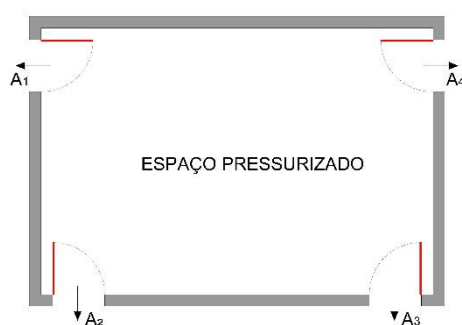
Figura 1 – Trajetórias de escape do ar em paralelo
