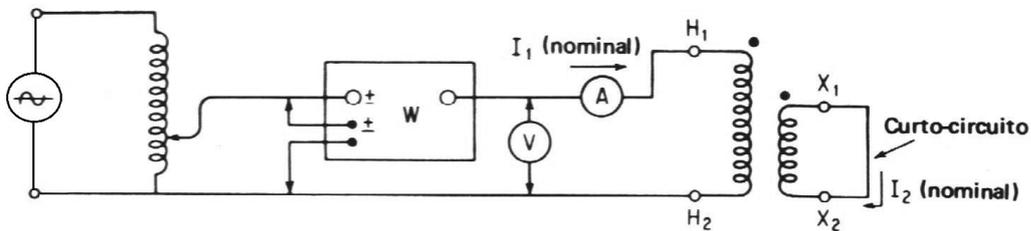
Nesse caso, a impedância e a resistência equivalentes referidas ao lado de alta tensão são, respectivamente, iguais a:
