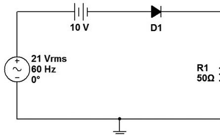
Considerando o diodo D1 de silício, a forma de onda da tensão sobre R1 está **corretamente** representada na alternativa:
