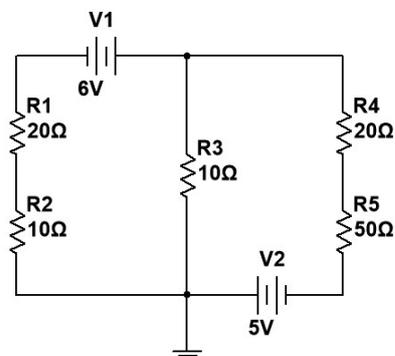
A tensão e a corrente através do resistor  $R_3$  são, respectivamente, iguais a:
