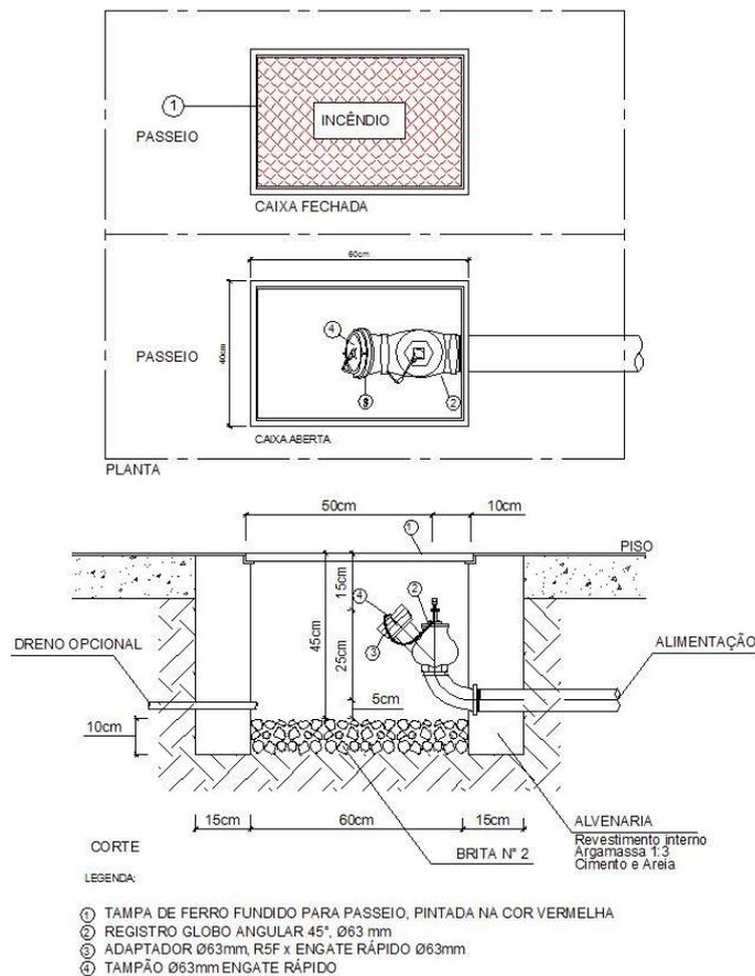
Figura 1 – Dispositivo de recalque no passeio público
