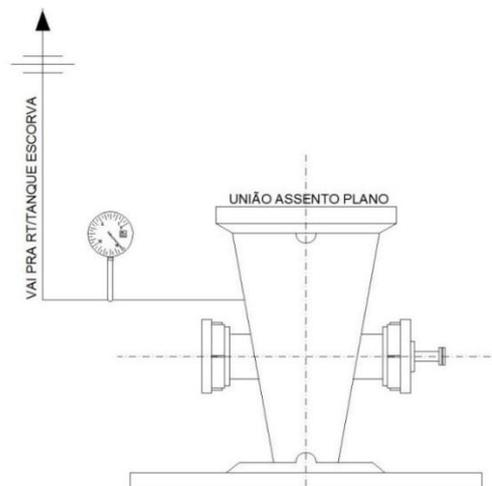
Figura C.6 – Arrefecimento da bomba principal elétrica
