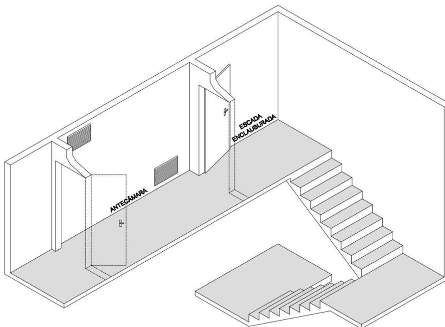
**Figura 14** – Antecâmaras e Duto de ar – Desenho esquemático
