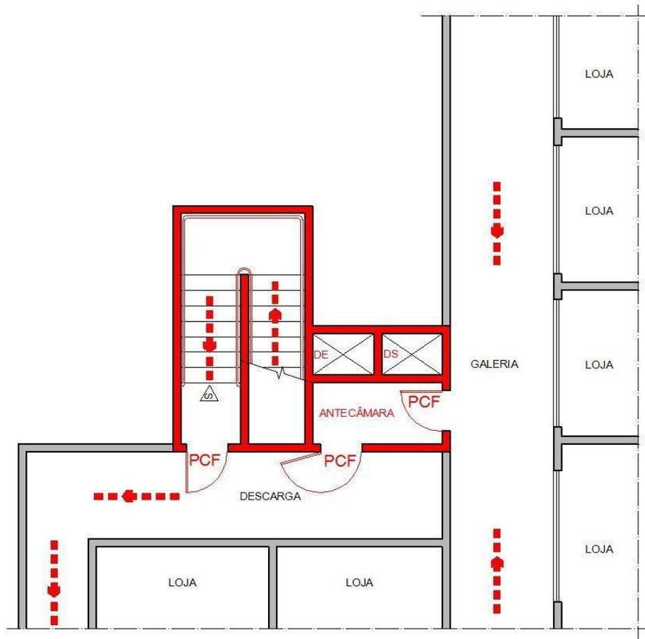
**Figura 24** - Acesso de galeria comercial à descarga
