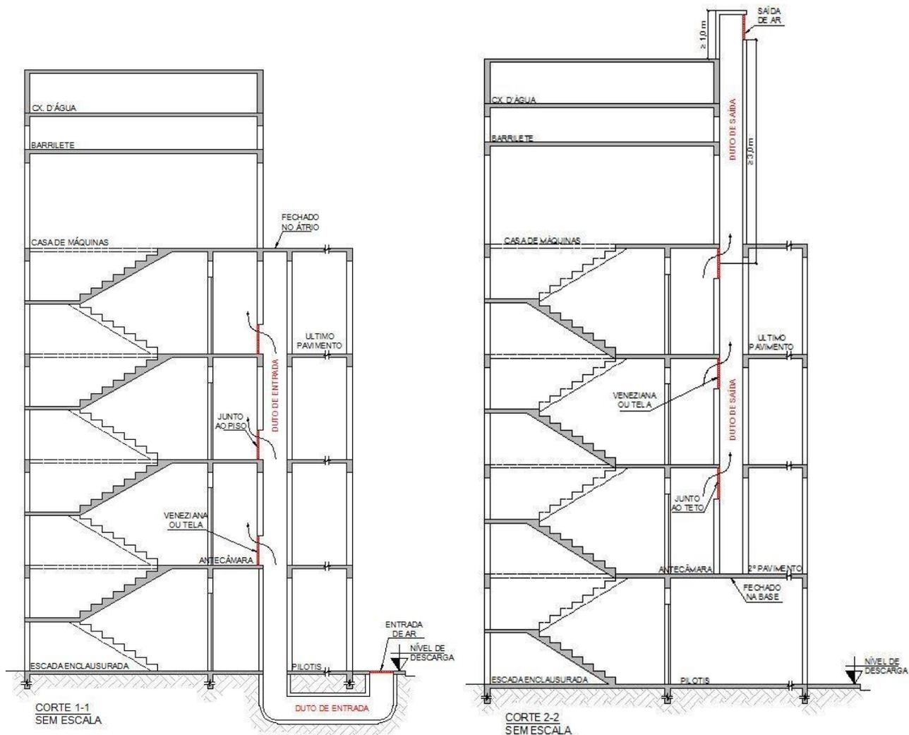
Figura 13 – Antecâmaras e Duto de ar – Desenho esquemático
