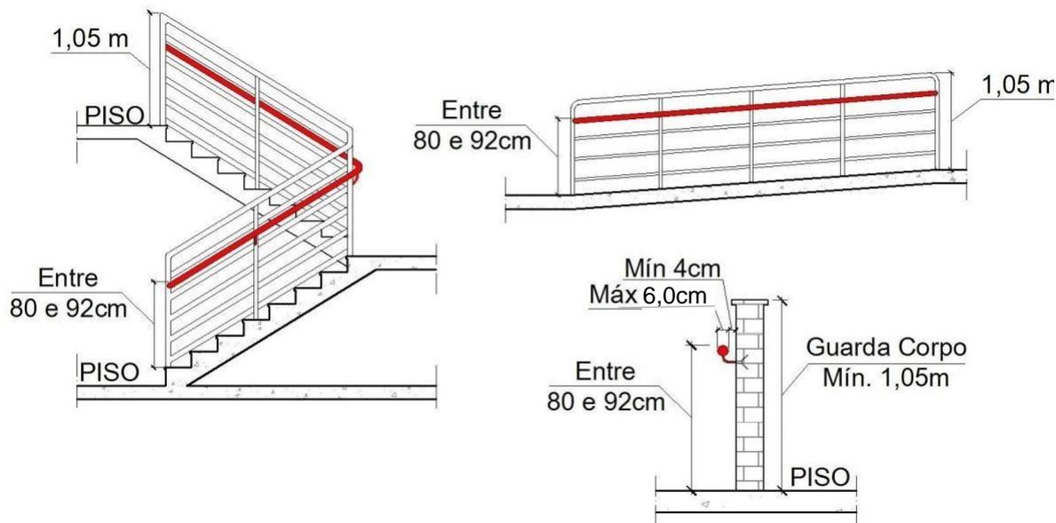
**Figura 18** - Dimensões de guardas e corrimãos
