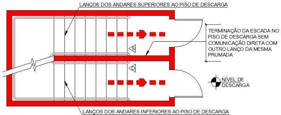
Figura 3 – Segmentação das escadas no piso da descarga
